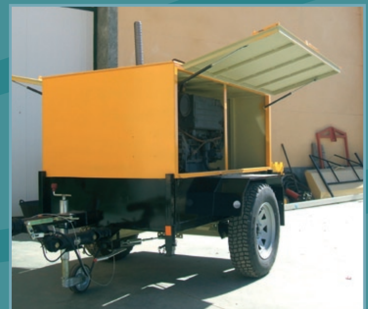
Remolque para grupos y motores. Puertas abatibles con amortiguadores.
