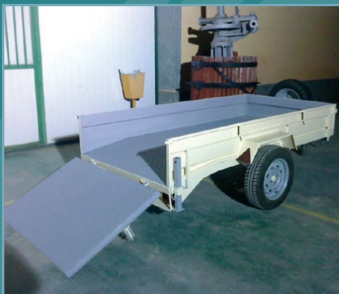
Plataforma lateral bajo, rampa subida. Mozos traseros para fijación.
