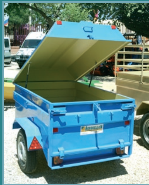
Tapa metálica con amortiguadores de gas.
