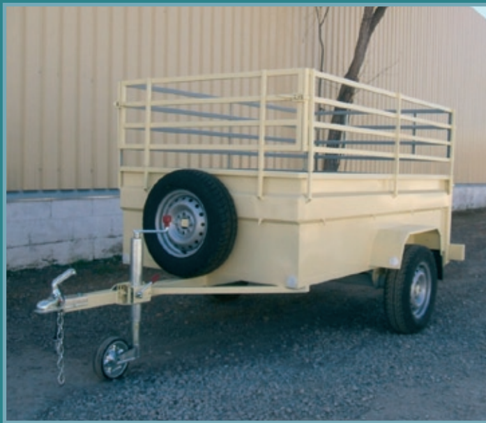
Sobre lateral en baranda.
